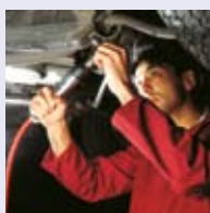
Ratschen- schrauber 200 l/min, 6-7 bar
