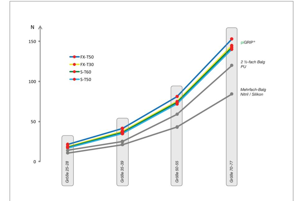
Geprüfte Funktion und Haltekraft im angegebenen Bereich. Mehr Informationen und Leistungsdaten finden Sie im Saugnapf Konfigurator unter [www.piab.com](http://www.piab.com).
