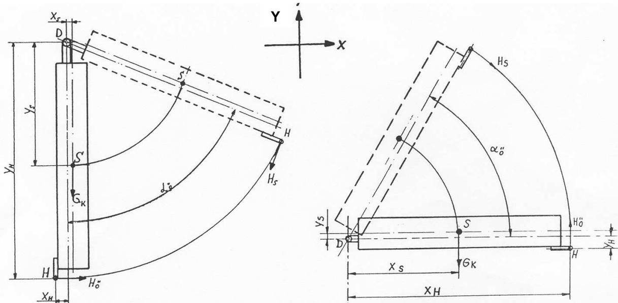
Wir empfehlen eine Mindest-Haltekraft von 20N bei -30°C in geöffneter Position.
