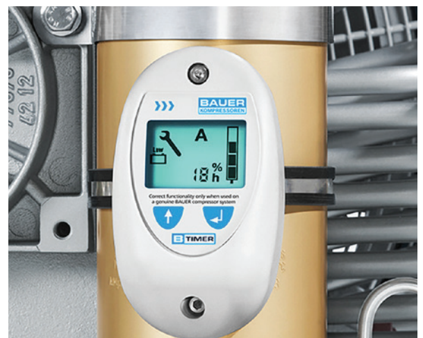
B-TIMER: Berechnung und Anzeige der noch verbleibenden Filterpatronenstandzeit sowie fälliger Wartungen
